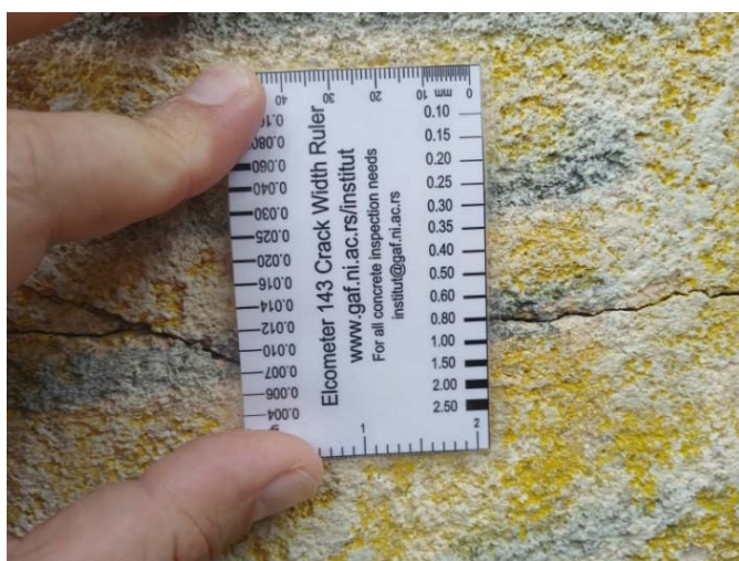
Slika 111. Prsline u zidovima aneksa (levo), pukotine na fasadnim zidovima širine do 22 mm (desno)
